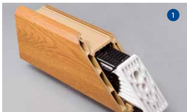
Schweißbeckverbinder in die Stahl-/Aluminiumverstärkung des Profils einführen.
