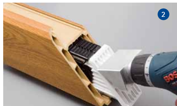
Den Schweißbeckverbinder mit dem Schrauber bis zum Anschlag in die Armierung einführen.
